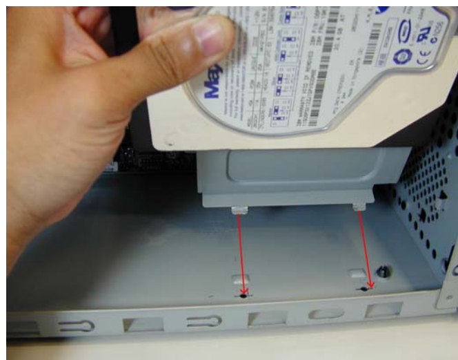
(圖 7) 將「2' nd HDD Tray」裝置底下的兩個凸起，插入主機底下的二個洞中。
