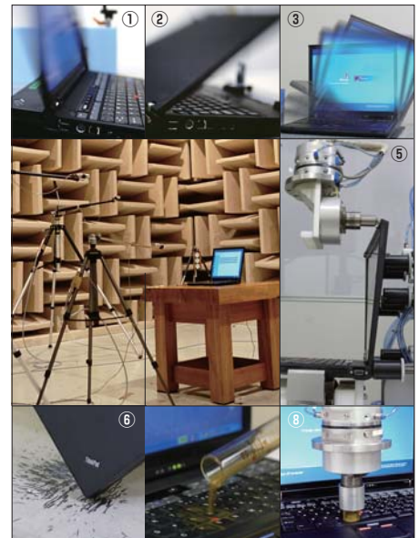
①②液晶ディスプレイ開閉試験：液晶ディスプレイを数万回開閉する。③動作時衝撃試験：装置のテーブルに固定し、さまざまな方向から衝撃を加える。④動作ノイズ測定試験：音響測定用の専用の部屋でThinkPadの出す音を測定する。⑤液晶ディスプレイひねり試験：液晶ディスプレイの片方を固定し、もう片方に圧力をかける。⑥角落下試験：衝撃が集中する8ヶ所の角それぞれから自由落下させる。⑦捲開試験/液体落下試験：キーボードに液体をこぼす。⑧キーボード圧迫試験：キーボードパームレストなどに圧力をかける。
